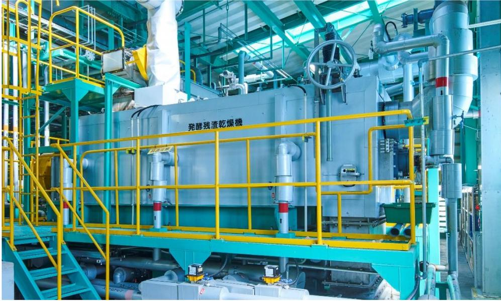
蒸気間接加熱式汚泥乾燥機
